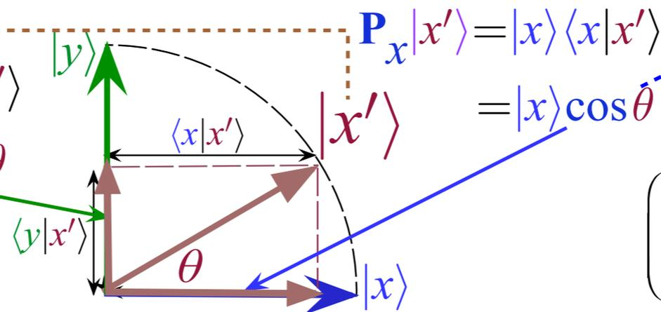
$$\begin{pmatrix} \langle x | \mathbf{P}_y | x \rangle & \langle x | \mathbf{P}_y | y \rangle \\ \langle y | \mathbf{P}_y | x \rangle & \langle y | \mathbf{P}_y | y \rangle \end{pmatrix} = \begin{pmatrix} 0 & 0 \\ 0 & 1 \end{pmatrix}$$
